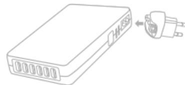
Zum Lösen des Adapters drücken Sie den Knopf 3 unterhalb des Adapters.
